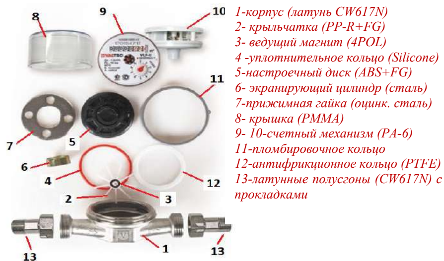
Рис.1 Конструкция счетчика в разобранном виде
