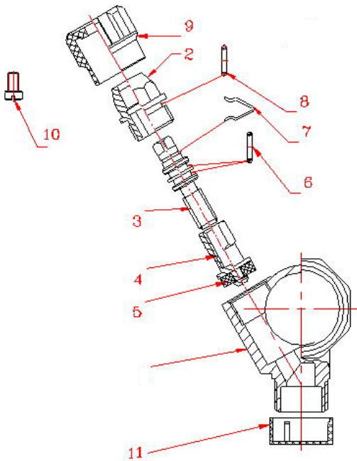
Коллекторы состоят из латунного (CW617N) корпуса 1 с гальванопокрытием из слоя никеля, имеющего на концах присоединительную резьбу (с одной стороны внутреннюю, с другой наружную) и встроенных в корпус регулирующих клапанов. Вращение латунного (CW614N) штока 3 приводит к линейному перемещению ползуна золотника 4 со сменной золотниковой прокладкой из EPDM 5, которая крепится к штоку винтом.
